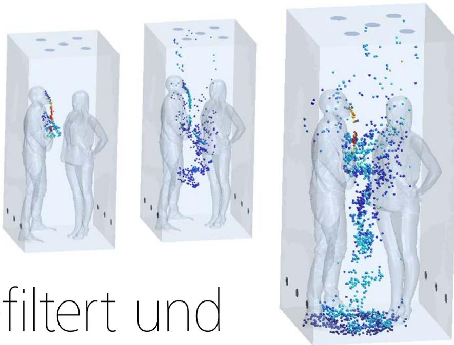
**Das Strömungsgeschehen in einer normalen Liftkabine: Die vom Passagier links ausgeatmeten Aerosole kontaminieren auch den Passagier rechts.**
